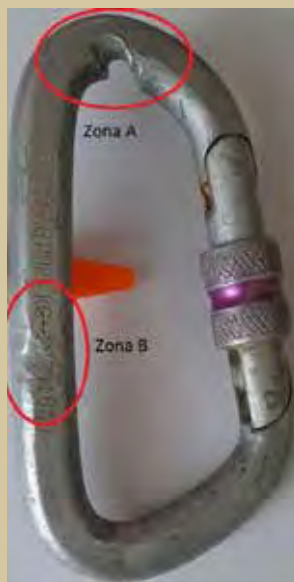
Foto di dettaglio del moschettone danneggiato.
