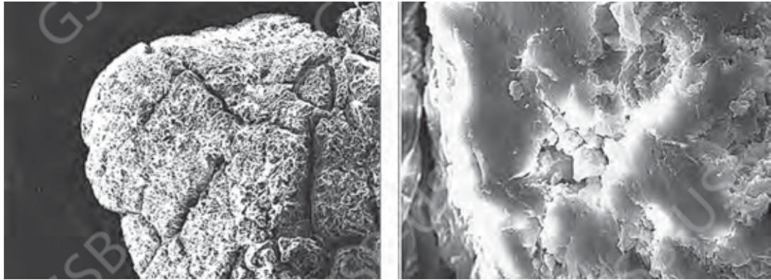
*Figura 10. A sinistra: immagine realizzata al S.E.M. di aggregati submicroscopici di malachite presente nel suolo campionato presso l'ingresso della miniera di Ca' Marsilio. A destra: aggregata submicroscopica di ossido di Ti rinvenuto anch'esso nel suolo antistante l'ingresso della miniera.*
