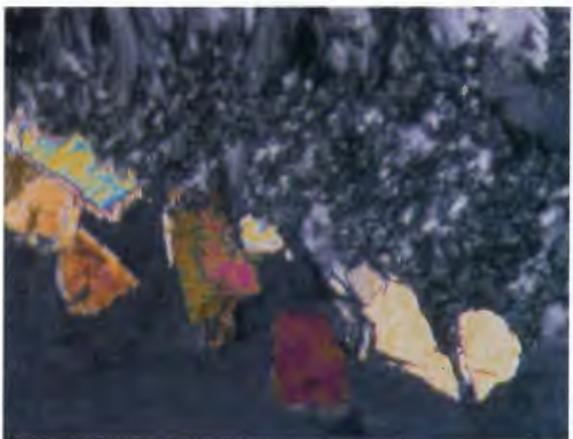
**Foto 9.** Livello alto: prismi relitti di Anidrite colorata a contatto con Gesso dalla tessitura xenotopica nuvoloso ameboide e microcristallina (Nicol X., dimensioni 3 x 2 mm).
