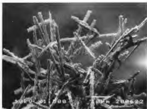
Fig. 3 – Immagine SEM del latte di monte. Si noti la caratteristica struttura dentellata dei singoli "bastoncini" che costituiscono il latte di monte.
