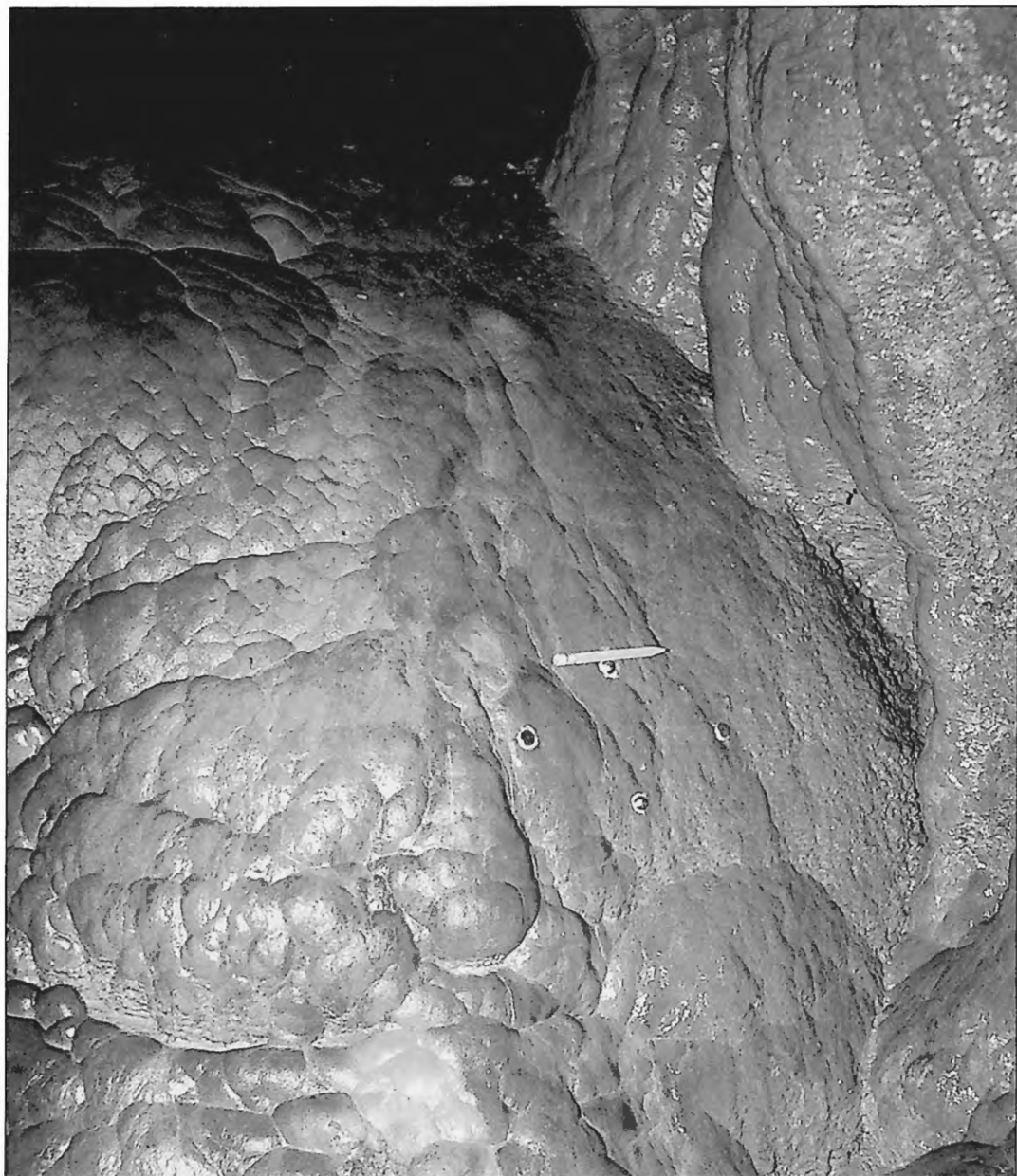
Foto 2- Una delle stazioni di misura della Grotta Novella : il rombo costruito dai quattro chiodi (due a testa piatta e due a testa emisferica) definisce due triangoli equilateri, ciascuno composto da due chiodi emisferici e da uno a testa piatta, al centro dei quali veniva periodicamente effettuata la misura con il micro-erosion meter.
