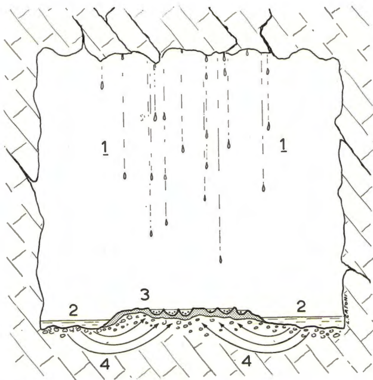
Fig. 3 - Schema della sezione della galleria della Miniera di Monteponi. 1) stillicidio di acqua carbonicata; 2) acqua salata; 3) vaschette di aragonite con all'interno le ooliti; 4) linee di arrivo dell'acqua salata nelle vaschette per capillarità.
